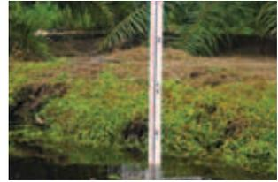
*Gambar 9: Alat pengukur ketinggian air untuk memonitor muka air di saluran pengumpul.*
